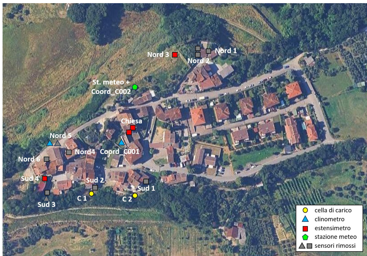
Figura 1 - Ubicazione dei sensori della rete wireless per il controllo delle deformazioni delle strutture. La sigla corrisponde alla denominazione del nodo a cui afferiscono i sensori.
